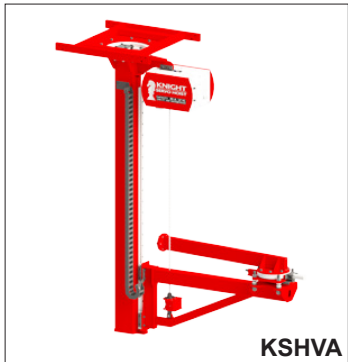
伺服葫芦结合垂直折臂吊 (吊顶式安装) 通过将葫芦安装在垂直的钢杆或铝杆上，创造了一个稳定的工作状态，消除了链条的堆积状况。 • 提升重量最重可达1000 磅
